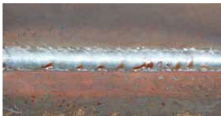
Рис 9.2. Сварной шов при максимальном значении индуктивности.
