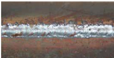
Рис 9.1. Сварной шов при минимальном значении индуктивности.
