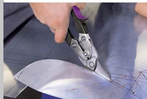
\* Ножницы можно кратковременно использовать для резки фальцев толщиной до 3 x 0,6 мм (1,8 мм).
