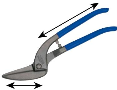
Обычные ножницы для резки листового металла традиционно имеют цельнокованые лезвия и рукоятки. Усилие резания зависит от соотношения длины лезвия и длины рукоятки.
