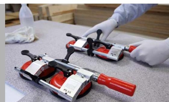
■ Для зажатия и позиционирования деталей с гладкой поверхностью, например, из керамики, гранита, Corian®, пластика, листового металла или стекла, для которых требуются малые зажимные усилия (до 260 Н)
